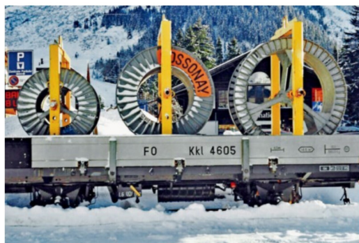
Der modernisierte Kkl 4605 mit Aluminiumaufbau 2001 in Andermatt.
