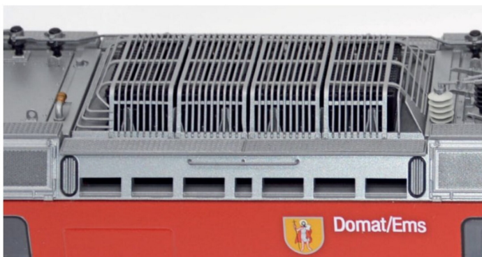
Dachdetail mit ausserordentlich feiner Widerstandsabdeckung, darunter die Bremswiderstände.
