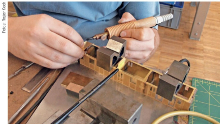
Präzises Arbeiten mit dem Widerstandslötgerät an einem Oldtimergepäckwagen.
