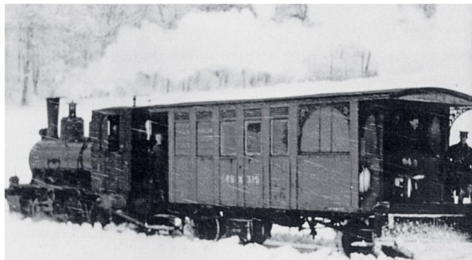
Der Wagen als OeBB-Dienstwagen X 315 mit Schneepflug und verglaster, geschlossener Galerie.
