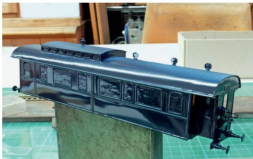
Spritzen des Wagenkastens, immer mit aufwendiger Abdeckarbeit verbunden.
