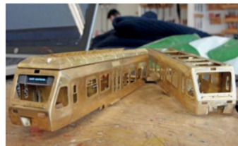
Das Rohbaugehäuse der NINA, links mit eingesetzter Matrixanzeige. Diese kann frei parametrisiert werden und Laufschriften anzeigen.
