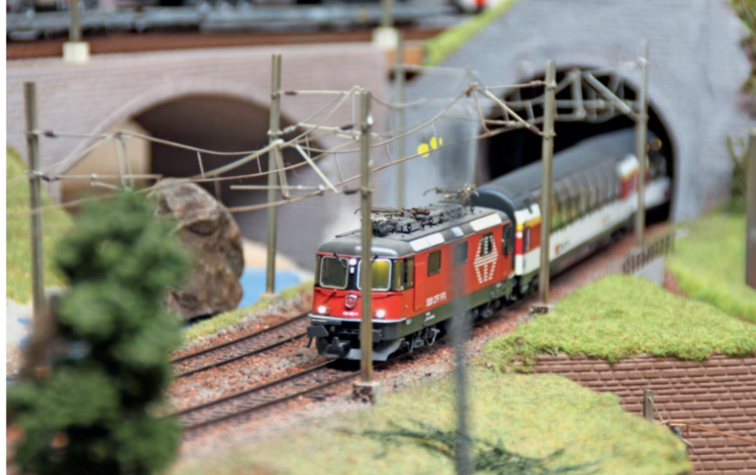
Die Loks auf Bruno Pfiffners Anlage sind alle mit Decoder ausgerüstet, einerseits zur Lastregelung, andererseits zur Tempofindung.
