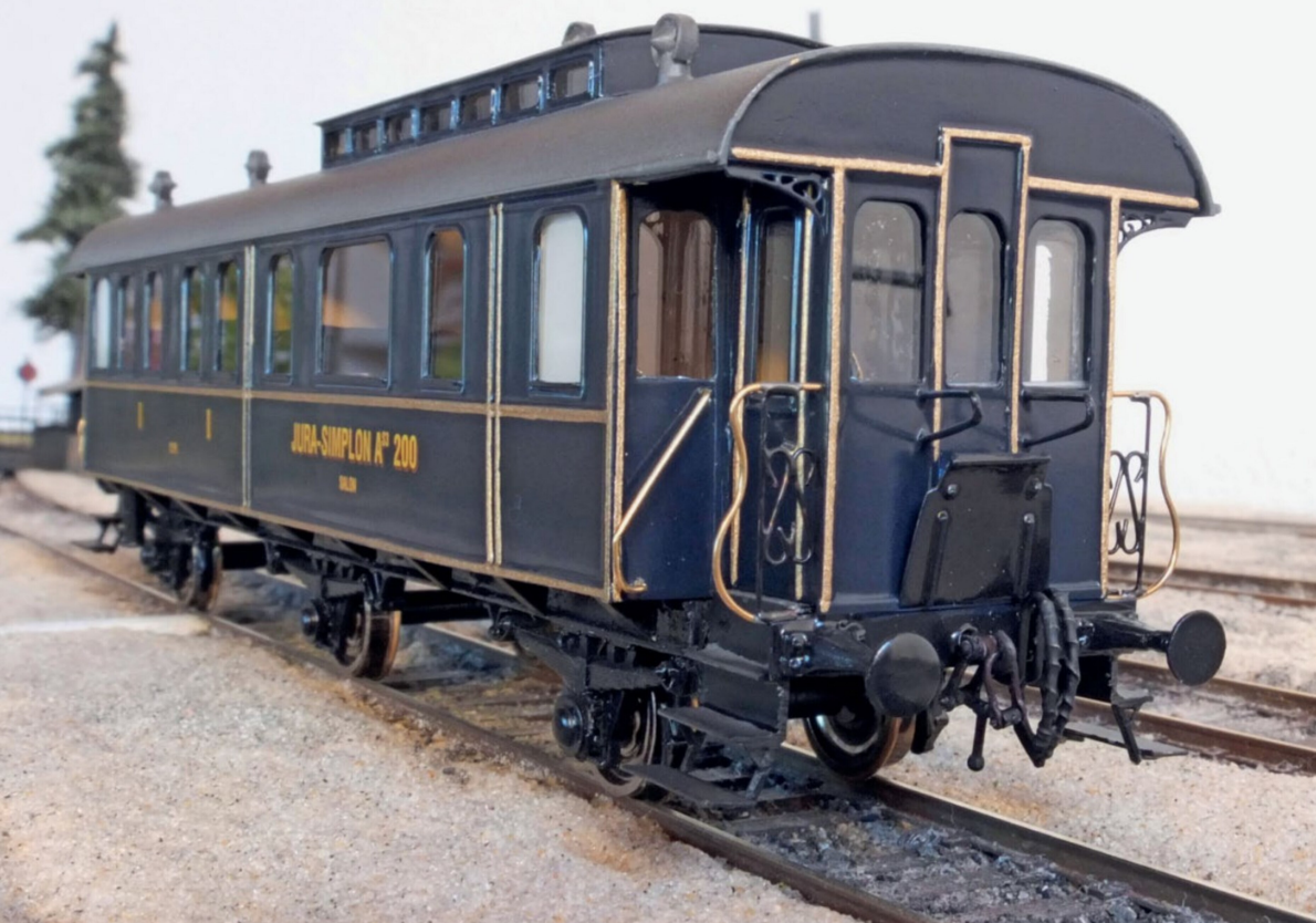
Ein tolles Stück: Die beiden Frontpartien mit den filigranen Gittern hat Christian Gohl total erneuert und die Radsätze gegen RP25 ausgetauscht.
