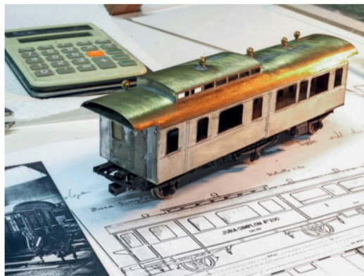
Rohbau vor der Montage der neuen Plattformen. Seitenwand unten gekürzt...
