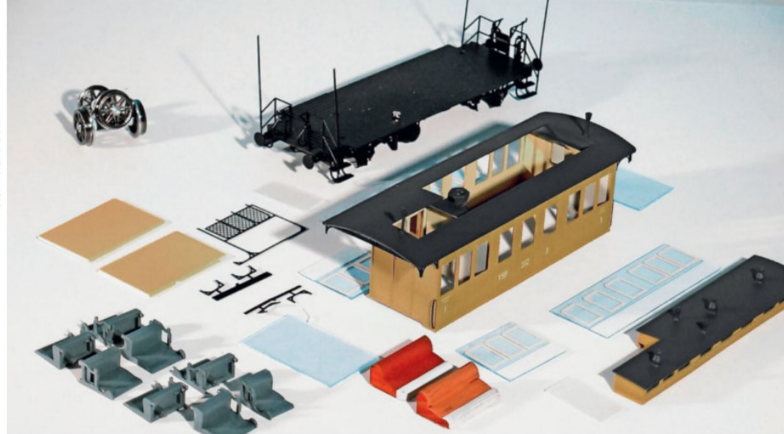
Sauber präsentierte Einzelteile des künftigen Wagens VSB A 352 im Massstab 1:87 in der Werkstatt des Modellbaustudios Born nach dem Spritzen und Beschriften.
