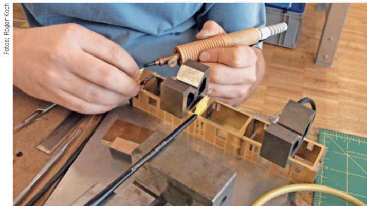
Präzises Arbeiten mit dem Widerstandslötgerät an einem Oldtimergepäckwagen.
