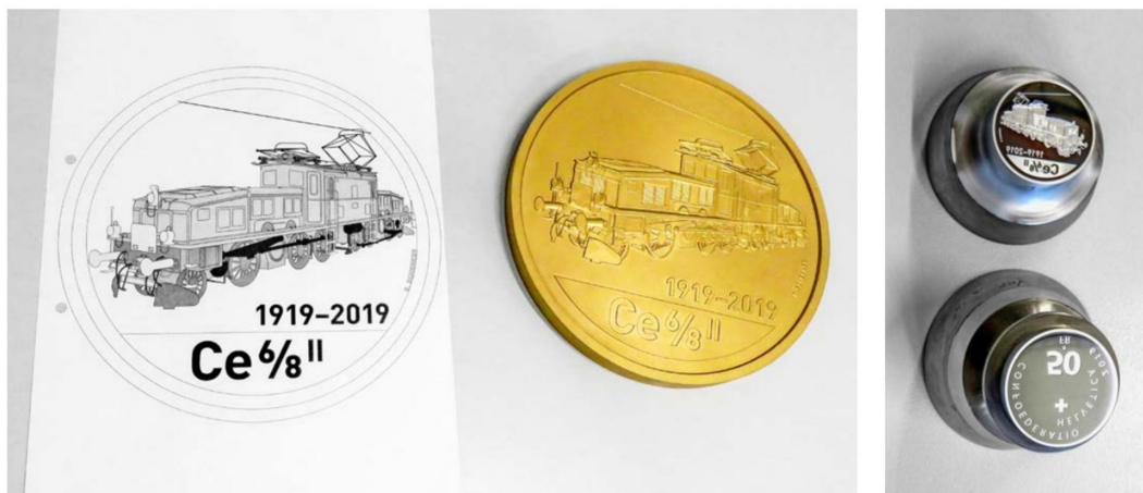
Mittels CNC-gesteuerter Fräse wird ein stark vergrössertes Kunststoffmodell erstellt. Dies dient zur Kontrolle und zur Abstimmung mit dem Künstler. Bis zur Fertigstellung der Prägestempel folgt eine Vielzahl von Arbeitsschritten. Mit einem Stempel können 500 bis 600 Sondermünzen geprägt werden.
