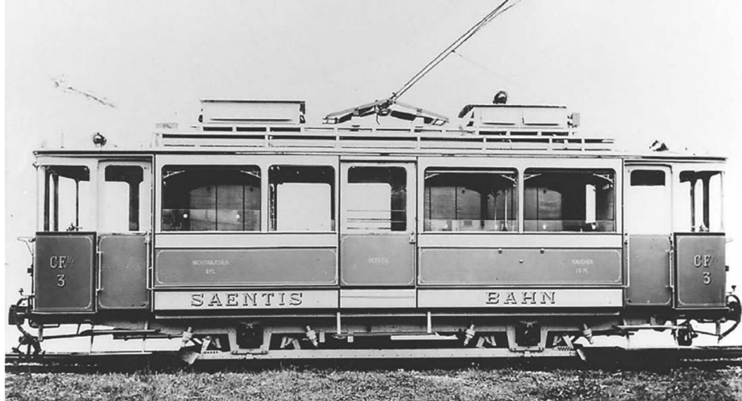
Bild 7: Werkfoto des CFe 3/3 der «Saentisbahn» von 1912, aus welchem später der heutige Te 3/2 Nr. 49 konstruiert wurde.
