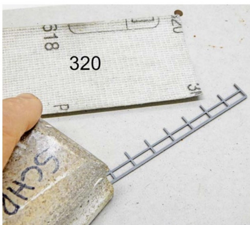
Mit 320er-Schleifpapier werden die glatten Seiten und der Pfosten angeschliffen.
