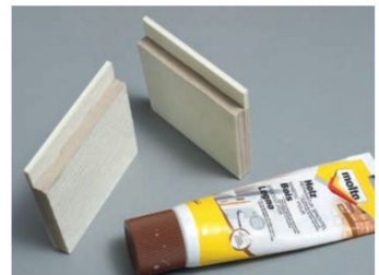
Die sichtbaren Flächen wurden mit Spachtelmasse eingestrichen und erhielten auch eine Prägung.
