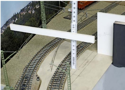
Die verwendete Oberleitung bedingt eine minimale Durchfahrthöhe, die durch Auflegen eines Reststückes ermittelt wurde.
