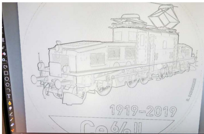
Am Bildschirm setzt ein Graveur den Entwurf des Grafikers in ein virtuelles 3-D-Modell um. Je nach Motiv kann dieser Arbeitsschritt zwei Stunden bis zu drei Wochen in Anspruch nehmen.
