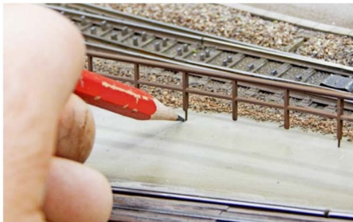
Die hervorragenden Enden der Pfosten mit Bleistift auf den Boden übertragen.
