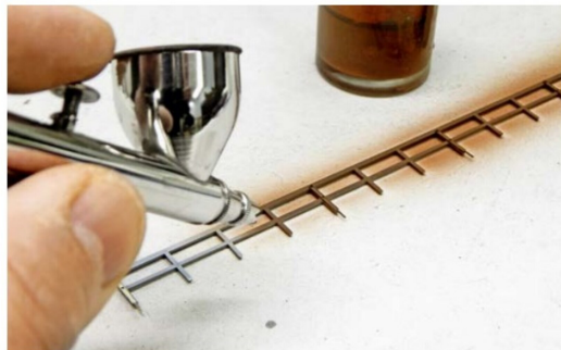
Nun die verdünnte rostbraune Farbe mit der Airbrushpistole auftragen.
