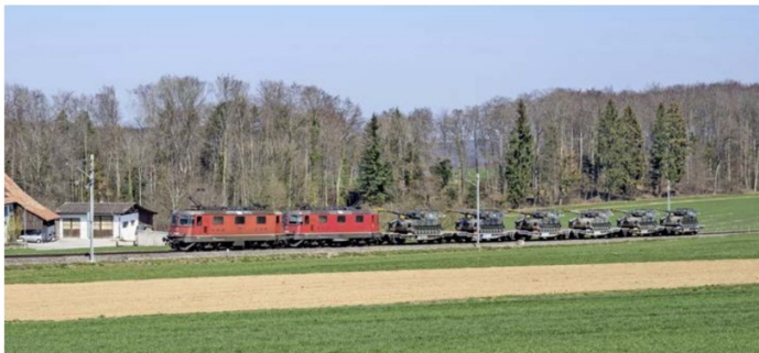
Die Re 420 306 und 263 ziehen in Vielfachsteuerung einen der drei Zugteile nach Bure.
