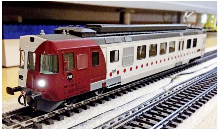
Wenn sich der Triebwagen in Parkstellung befindet, so leuchtet beidseitig je ein Scheinwerfer.
