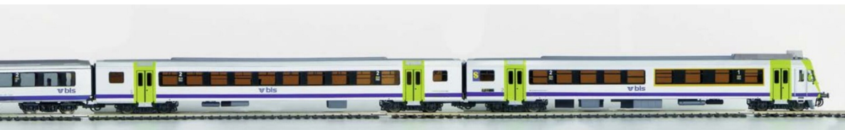
Der ABt-Steuerwagen der BLS nach dem Spritzen und nach der Beschriftung. Die bereits angebrachten Piktogramme wurden allesamt als vierfarbige Anreiber hergestellt.
