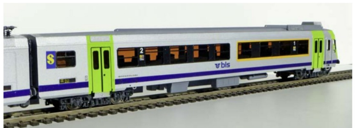
Der ABt-Steuerwagen der BLS nach dem Spritzen und nach der Beschriftung. Die bereits angebrachten Piktogramme wurden allesamt als vierfarbige Anreiber hergestellt.
