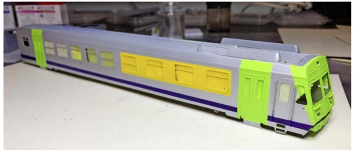
Der Steuerwagen der BLS noch während der Lackierarbeiten: Es fehlt der schwarze Farbauftrag im Bereich der Fenster, jedoch sind bereits die gelben Erstklassstreifen angebracht.
