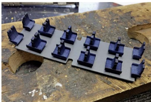
Die 3-D-gedruckten Einzelsitze der Inneneinrichtung während der Montage.
