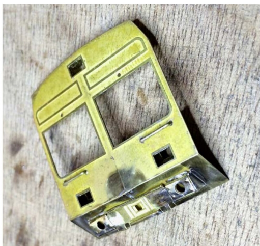
Im Gegensatz zur TPF-Ausführung wird die Front der BLS als separate Baugruppe hergestellt. Sie wird stirnseitig auf den Wagenkasten gelötet.
