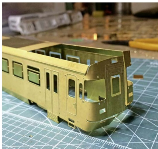
Das Gehäuse des Steuerwagens ist gebogen, aber noch nicht verlötet. Die Front der TPF-Endwagen ist in die Seitenwände integriert.
