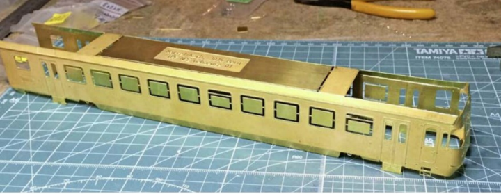
Das Gehäuse des Steuerwagens ist bereits zurechtgebogen. Das Wagendach wird als separates Teil zurechtgebogen und anschließend mit dem Gehäuse verlötet.
