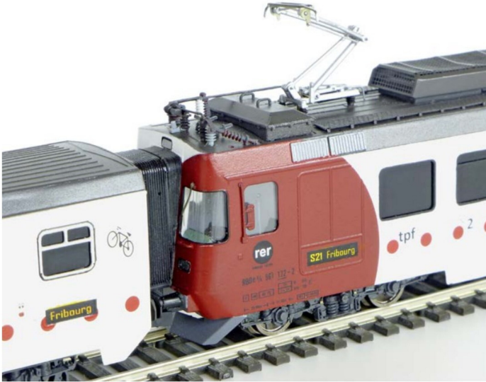
Der Faltenbalg als Übergang zwischen Trieb- und Steuerwagen wurde aus Ersatzteilen der Liliput-Leichtstahlwagen hergestellt. Falls der Triebwagen solo eingesetzt wird, kann der Balg entfernt werden.
