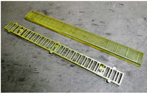
Die Widerstandsabdeckung und der Kasten bestehen aus zwei Teilen und werden als Ganzes auf dem Dach des Triebwagens festgeschraubt.
