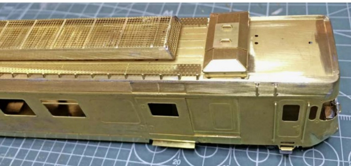
Der Fahrzeugaufbau am Triebwagen: Die Fronten, die Spanten und der untere Rahmen sind ebenfalls bereits eingelötet. Das Gehäuse ist nun bereit, das Dach zu tragen.
