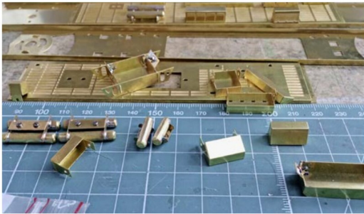
Details für den Wagenboden. Die Kästen und Lufttanks werden nur grob angedeutet. Hier sind die ersten Kästen und Luftbehälter bereit zum Einbau.
