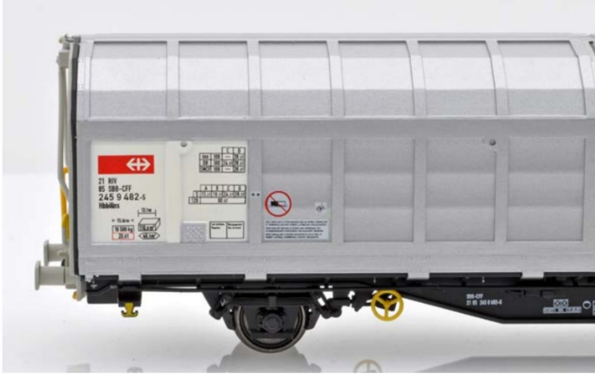
Sehenswerte Details: horizontale Sicken an den Seitenwänden und ein Handbremsrad.
