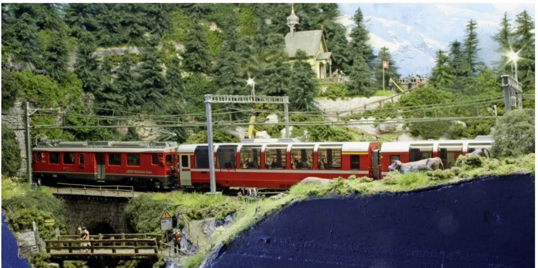
Die Oberleitung und die Schaltposten sind selbst gebaut, aus Messingprofilen und Messingdraht. Die Querverbindungen und Isolatoren sind von Sommerfeldt.
