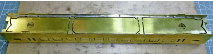
Der Fahrzeugaufbau am Wagenkasten: Der Rahmen und die Spanten sind bereits eingelötet. Die drei «Füllbleche» müssen natürlich später noch entfernt werden.
