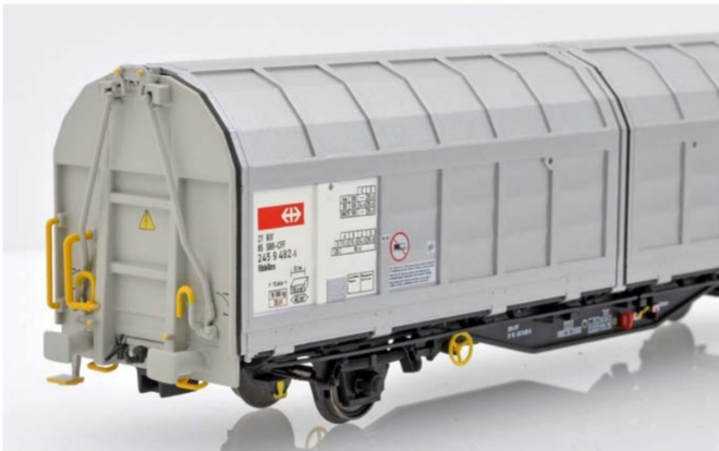
Ansicht der Stirnseite mit dem nachgebildeten Verschlussmechanismus.
