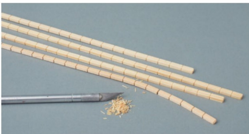
Die Mauerkronensteine entstanden aus filigranen Holzprofilen, in welchen die Mauerfugen mit einem Skalpell eingeschnitten wurden.
