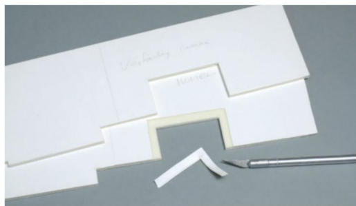
Die zu bauende Mauer besteht aus zwei 5 mm dicken Platten. Im Bereich, wo innen die Unterführung hinkommen soll, wurde der Karton bereits entfernt.
