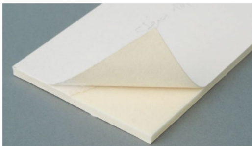
Aussen wurde der Karton der Sandwichplatten komplett entfernt, damit die gewünschten Mauerfugen anschliessend geprägt werden konnten.
