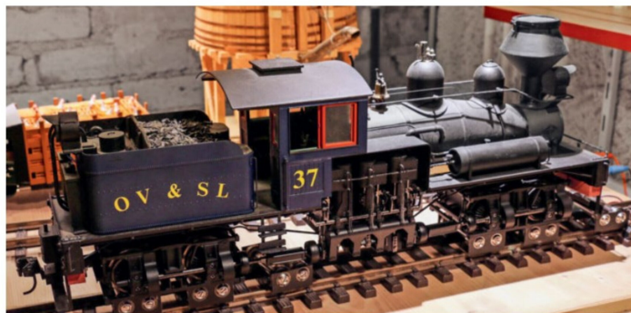
Die 3-Zylinder-2-Drehgestell-Shay-Lok mit dem typischen Seitenantrieb und stehender Dampfmaschine auf den Rollen im Soundlabor, um die aus den USA mit nach Hause gebrachten und eingebundenen Kegelzahnradklänge fein abzustimmen. Aufgenommen wurden sie bei der Talfahrt einer Shay-Lok.
