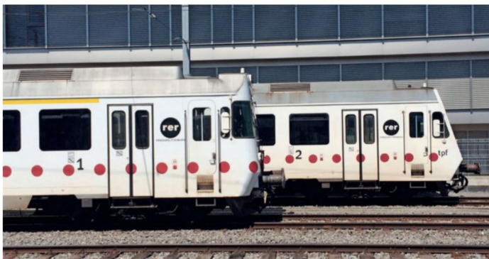
TPF-Steuerwagenfronten am 21. Mai 2016. Hier sind die zwei unterschiedlichen Profile der Frontpartien der Steuerwagen sichtbar. Im Vordergrund der Abt 371, dahinter der Abt 361.
