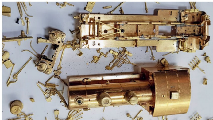
Auslegeordnung von den Bauteilen der mehr als 350 Ätz- und Gussteile des Modells. Eine grosse Zahl dieser Einzelteile musste mit CAD in unzähligen Planformaten aufgezeichnet werden.
