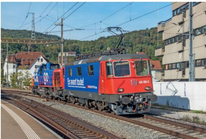
Bei der SBB Cargo sind nun rund 100 Güterwagen und 25 Triebfahrzeuge der Typen Re 420, Am 843 und Tm 232 auf automatische Kupplung umgebaut. Mit dieser Flotte startet Mitte Februar 2019 der Pilotversuch mit automatischer Kupplung im kombinierten Verkehr. Bei den Lokomotiven kommen klappbare Hybridelektrische Kupplungen zum Einsatz, sodass diese auch weiterhin mit Fahrzeugen mit Schraubenkupplung gekuppelt werden können. Inwiefern sich diese teure Mechanik bewährt, wird der Versuch zeigen.
