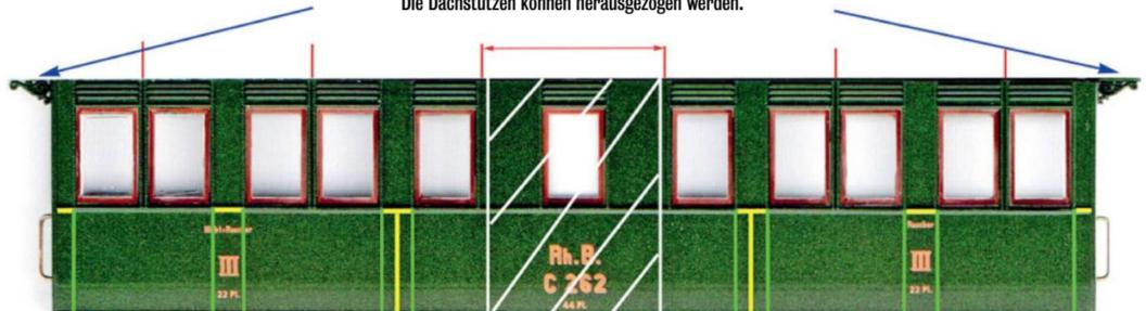
Hier sieht man, was am Wagenkasten des C 262 geändert werden muss, um den kürzeren Wagen zu bauen. Bei den weißen Linien wird abgeschnitten respektive getrennt. Die gelben Linien zeigen, was mit dem kleinen Stechbeutel abgeschliffen werden muss. Bei den grünen Linien müssen die neuen Leisten angebracht werden. Die roten Striche zeigen den Abstand zwischen den Fenstern. Die Leisten müssen gleichmäßig verteilt sein.
