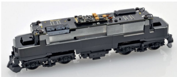
Ein von Roco gewohntes aufgeräumtes Innenleben mit Sounddecoder und Pufferkondensatoren.
