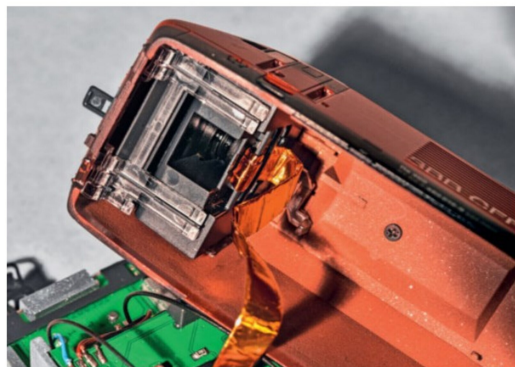
Die Kamera ist im Lokgehäuse gut versteckt in einem Führerstand untergebracht. Das Objektiv der Kamera ist in der Bildmitte sichtbar.
