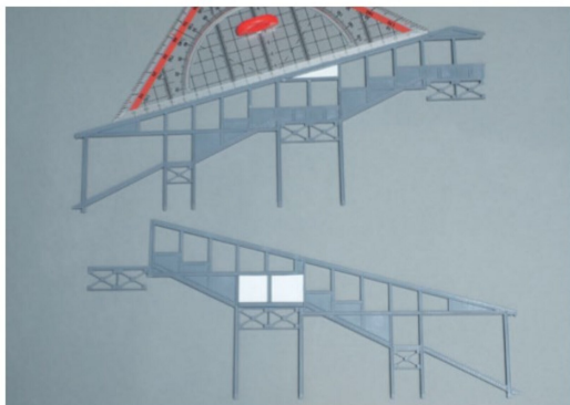
Damit die Dachträger gerade verlaufen, wurden sie während des Klebens an einem Lineal ausgerichtet. Die weissen Füllstücke sind bereits eingeklebt.
