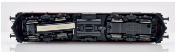
Eine Ansicht des Unterbodens vom Modell der AC-Version mit Schleifer.
