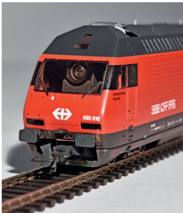
Blick in den Führerstand: Die Kamera ist geschickt hinter der Frontscheibe untergebracht.
