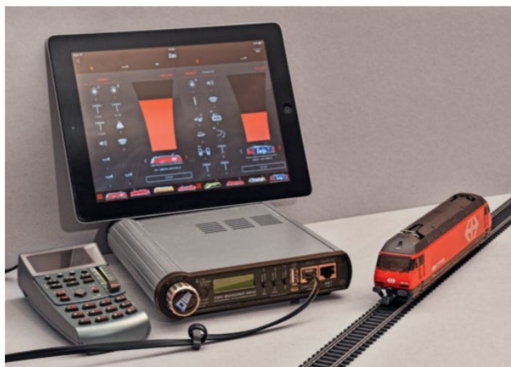
Die Hardwarekonfiguration für den Betrieb im Host-Modus. Das Tablet dient wahlweise als Eingabegerät oder Kamerabildschirm.
