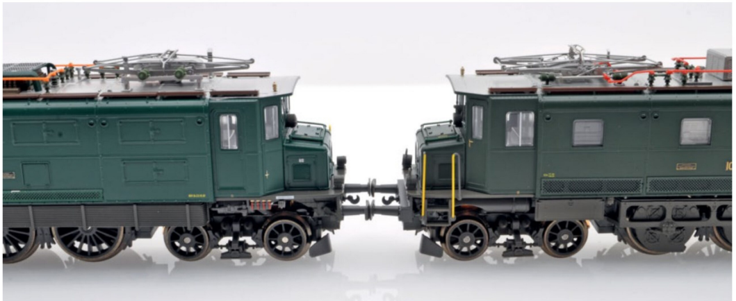
Die Ae 4/7 10913 (BBC) (links) und die Ae 4/7 10990 (MFO) (rechts) Puffer an Puffer. Gut zu sehen ist die verlängerte Pufferbohle der MFO-Ae 4/7.
