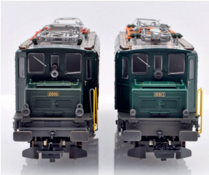
Die Frontansicht der beiden verschiedenen Ae 4/7 mit unterschiedlichen Lampen.
