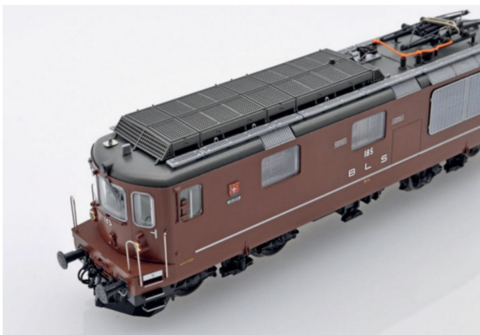
Das Lokomotivdach wird geprägt von der grossen Bremswiderstandsabdeckung.
