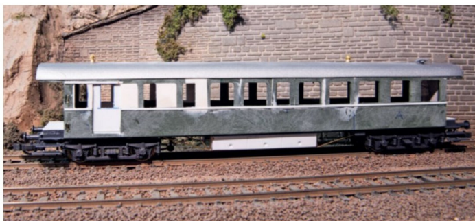
Das Gepäcktor ist ein entsprechend angefertigtes Kunststoffteil, welches aufgeklebt wurde.
