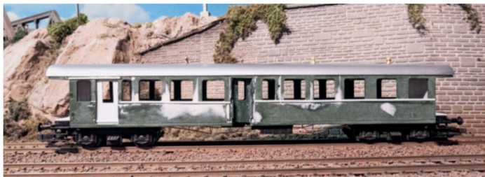
Fertig geschliffen, gespachtelt und im Rohbau fertiggestellt. Man sieht hier die Blechabdeckungsleiste über dem unteren Rand des Kastens und die eingeritzte Rille, die den Chassisrahmen deutlich markiert.
