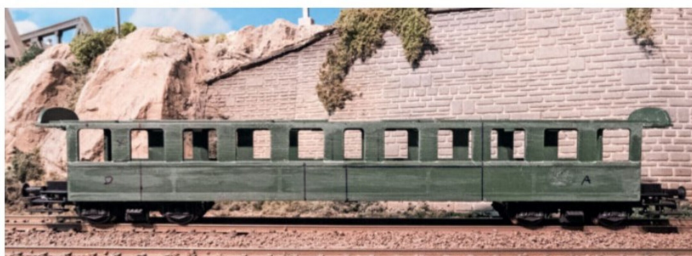
Der Wagenkasten ist geschliffen, und die ersten Schnitte sind mit eingezeichnet.
