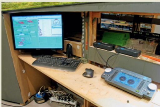
Steuergerät mit ESU-ECoS-PC, digitaler Steuereinheit und zwei Boostern.
