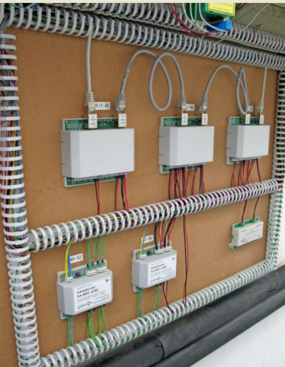
Elektrische Stationsschalttafel: die Rückmeldemodule, darunter zwei Decoder zur Steuerung der Weichen und schliesslich das Lenz-Kehrschleifenmodul.
