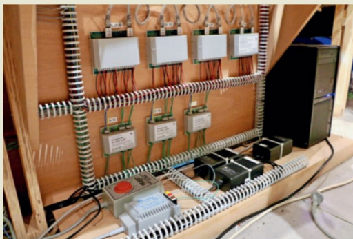
Unten die Transformatoren für verschiedene Stromversorgungen und Verstärker. Darüber Feedback-Module und Decoder für Weichenmotoren.
