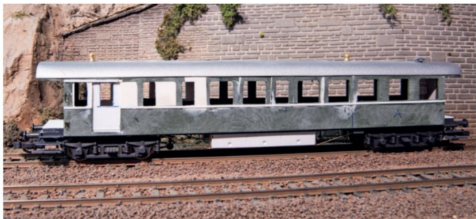
Das Gepäcktor ist ein entsprechend angefertigtes Kunststoffteil, welches aufgeklebt wurde.
