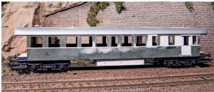
Alle Teile sind angebracht, der Kasten ist geschliffen und gespachtelt, nun kann die Lackierung kommen.
