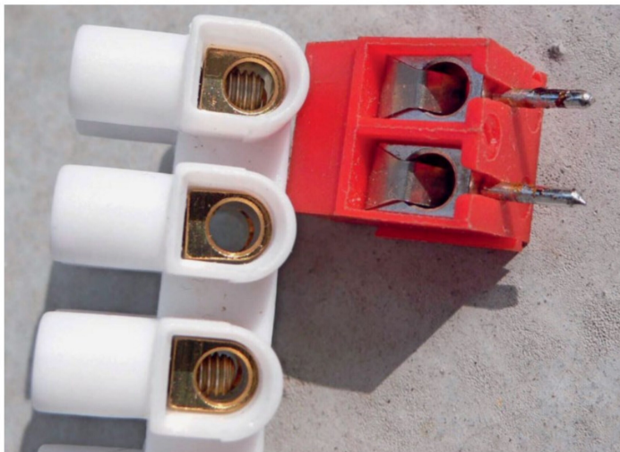
Eine Lüsterklemme ohne (links) und eine Schraubklemme mit Drahtschutz (rechts).
