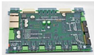
ZIMO hat in Bauma ein Konzept vorgestellt, auch in der Tradition der MX8- und MX9-Module, welches die Belange aller stationären Einrichtungen zusammenfasst, das Stationäreinrichtungsmodul «StEin». Dieses Konzept erleichtert die Installation und Inbetriebnahme, ermöglicht eine komfortable Überwachung der Steuerungstechnik selbst und erleichtert die Fehlersuche.
