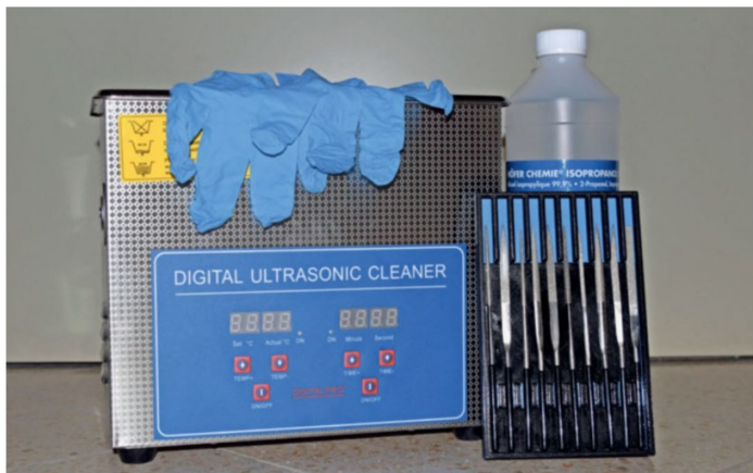
Für Resin-3-D-Druck sollte zumindest diese Grundausrüstung zur Nachbearbeitung eingesetzt werden.
