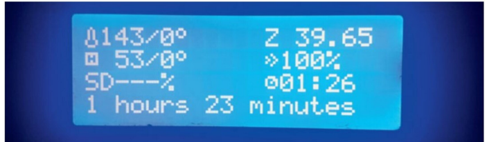
Die Druckdauer für den Waggonaufbau war bei 0,15 mm dicken Schichten nicht übermässig lang.
