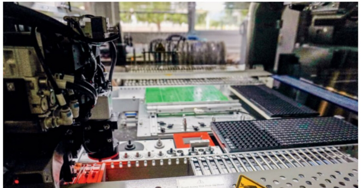
In dieser Maschine werden Platinen montiert. Gerade steht sie still, Vorbereitungen sind am Laufen.
