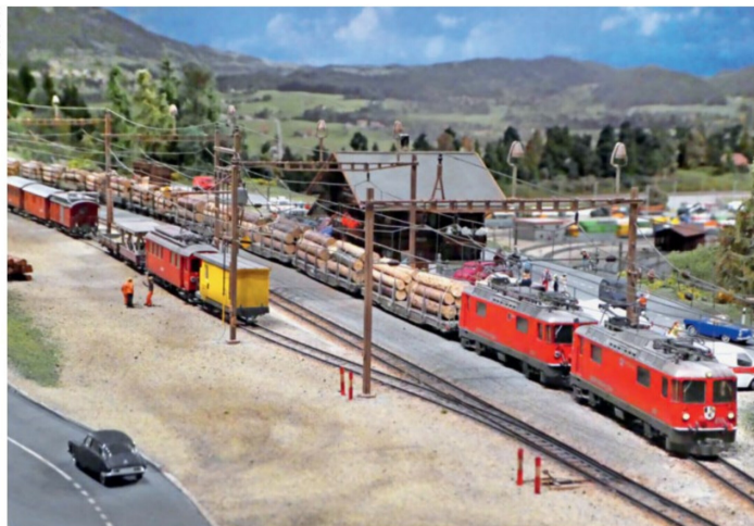
2 Ge 4/4 II , 3,3 MW, 100 t, Last: 32 Achsen, 286 t, V-max. 55 km/h.
