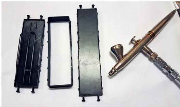
Nach der Nachbearbeitung folgt das Lackieren. Klassische Emailfarben von Revell haben sich bewährt.
