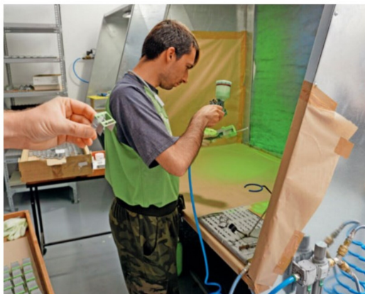
Die Führerkabine eines BLS-Robots wird gerade mit grüner Farbe besprüht.
