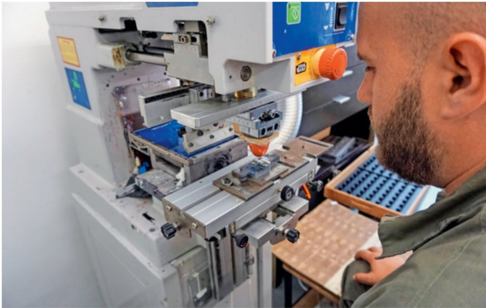
Führerkabinen werden mit dem BLS-Logo bedruckt. In der Fachsprache heisst das «Tamponierung».
