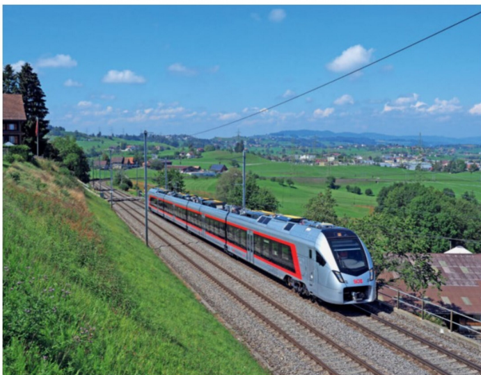
In voller Steigung: der RABe 526 002 oberhalb Samstagen auf Probefahrt in der 50‰-Rampe.
