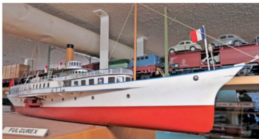
Das Schiffsmodell von Fulgurex verfügt über einen Echtdampfantrieb.
