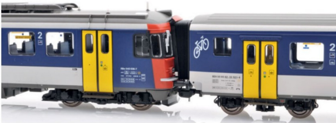
Mit dem Faltenbalg entsteht ein geschlossenes Zugbild zwischen Trieb- und Steuerwagen.
