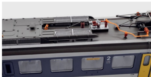
Feine Nachbildung des Hauptschalters und der 15-kV-Dachleitung.
