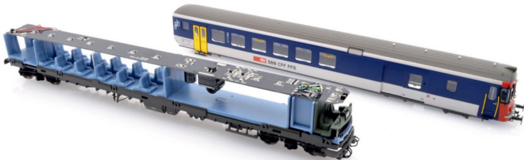
Einblick in das aufgeräumte Innenleben des Steuerwagens BDT EW II mit durchgehender Elektronikplatine im Dach.
