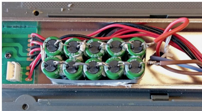
Die Kondensatorenbatterie für den störungs- und unterbrechungsfreien Fahrbetrieb.
