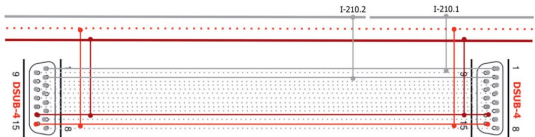
Verdrahtungsschema der D-SUB-Verbindung im Modul 1.
