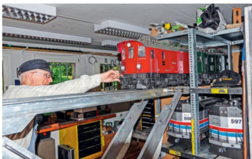
... wurde eine Hebeeinrichtung mit Bühne und Gleisen gebaut.
