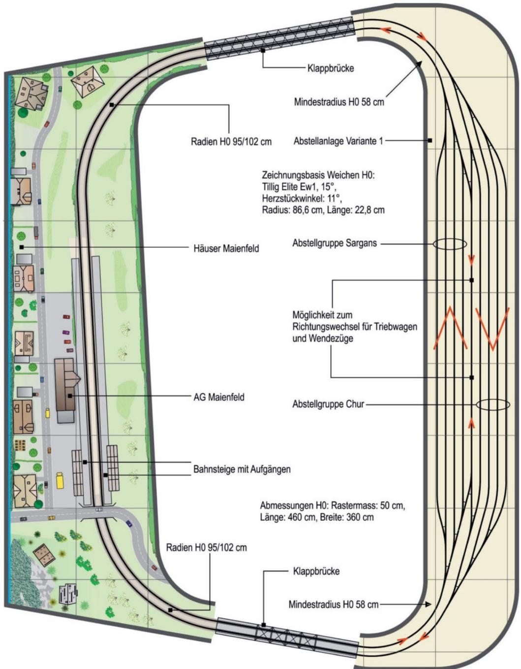
Die Variante 1 besteht aus zwei Anlagenschenkeln mit dem Bahnhof Maienfeld mit zwei Außenbahnsteigen und einem Abstellbahnhof mit richtungsgebundenen Gleisgruppen sowie einem Gleis zur Richtungsänderung von Triebwagen respektive Wendezügen. Verbunden sind die beiden Schenkel durch Klappbrücken, oder der Betreiber muss bei gespannter Oberleitung unten durchkrabbeln.
