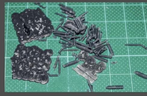
Beim Drucken mit Resin fällt einiges an Abfall an, der einfach abgeschnitten werden kann, mit einem scharfen Cutter oder einem Seiten-schneider.
