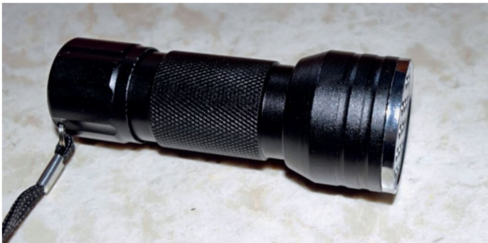
Nach dem Anbringen des Rohrs kann das Resin mit einer UV-Taschenlampe ausgehärtet werden.
