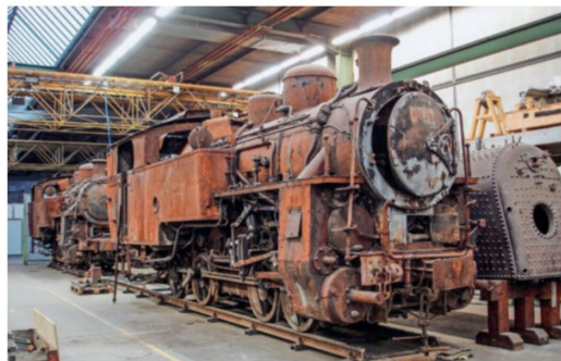
So sah die Dampflokomotive HG 4/4 Nr. 704 der Dampfbahn Furka-Bergstrecke aus, als 2006 die Restaurierungsarbeiten begannen.
