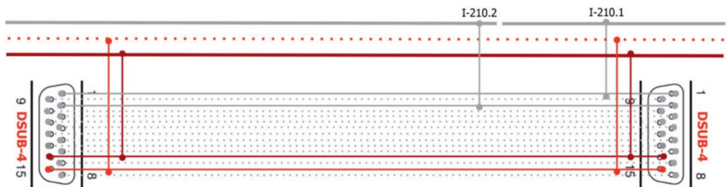
Verdrahtungsschema der D-SUB-Verbindung im Modul 1.
