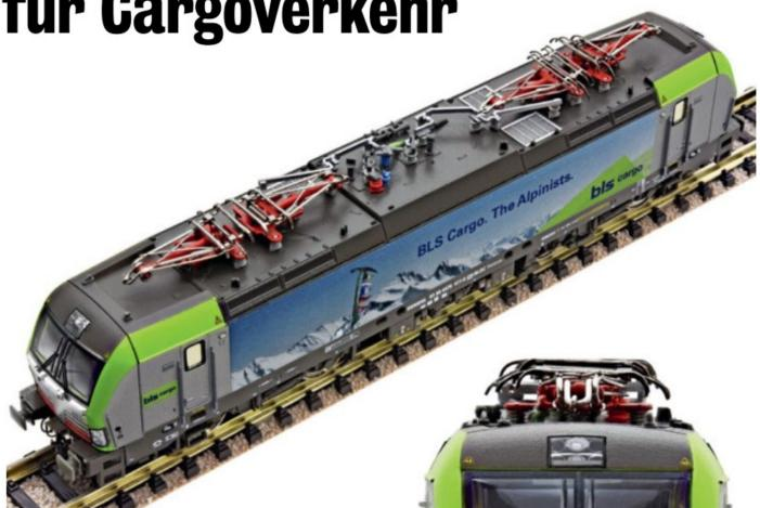
dem weist das Modell eine Schnittstelle nach NEM 662 (Next18) zur Aufnahme eines Decoders, Kupplungsaufnahme nach NEM 355 mit Kulissenmechanik und eine weiß-rote LED-Dreilicht-Spitzenbeleuchtung, mit der Fahrtrichtung wechselnd, auf. Die Stirnbeleuchtung kann mithilfe eines Mikroschalters ganz oder teilweise abgeschaltet werden. Verspiegelte Seitenfenster geben dem Lokmodell zusätzlichen Pfiff.
