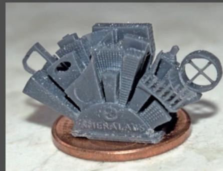
Der Duplicator D7 – ein Resin-Drucker – druckt mit sehr hoher Auflösung. Hier hat sich allerdings Wüstenstaub während des Aushärtens am Sonnenlicht abgesetzt.
