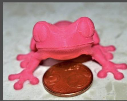
Gedrucktes Objekt mit dem Prusa i3 MK2S, einem weiteren FDM-3-D-Drucker. Wie man auf dem Bild sieht, ist die minimale Schichtdicke noch gut erkennbar.
