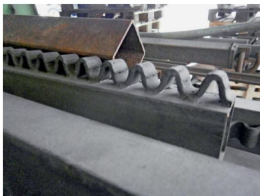
Eine Detailansicht der selbst erstellten und verwendeten Zahnstange.
