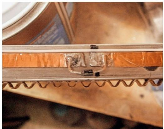
Seitliche Stromschiene aus Kupfer, hier mit einer Trennung und einer Diode.
