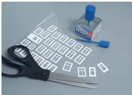
Die Fensterrahmen wurden mit Plastic Magic auf die Fensterfolie geklebt und erst im Anschluss bequem mit einer Schere ausgeschnitten.
