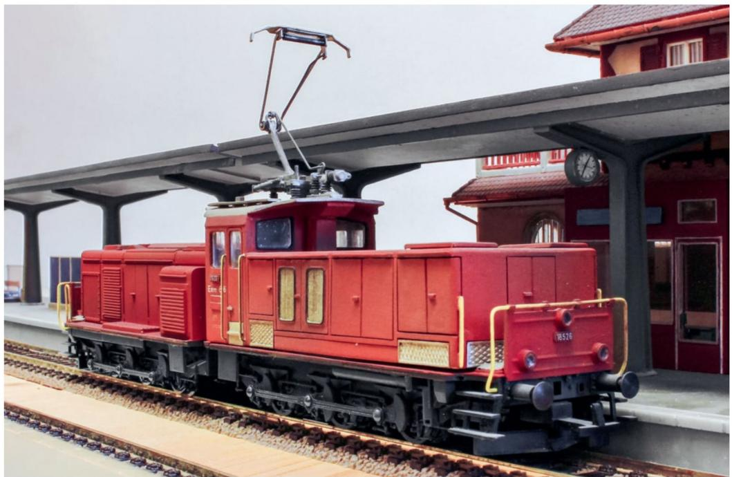
Für die SBB-Rangierbahnhöfe Basel und Chiasso wurden in den Jahren 1970/71 sechs sogenannte Zweikraftrangierlokomotiven geliefert, welche in der Mitte ein Gelenk hatten. Eigentlich sind dies zwei kurzgekuppelte SBB Em 3/3 oder SBB Ee 3/3 IV. Auf der Lokseite mit dem Führerhaus befindet sich der elektrische Teil, auf der anderen Fahrzeughälfte der Generator, der Zwölfzylindermotor und der Kühler. Der
