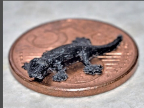
Bei kleinsten Objekten kommt der Anet A6 an seine Grenzen. Dieses Schicksal teilt das Gerät aber mit den meisten FDM-3-D-Druckern.
