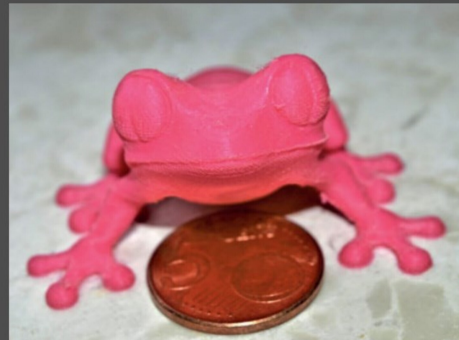
Gedrucktes Objekt mit dem Prusa i3 MK2S, einem weiteren FDM-3-D-Drucker. Wie man auf dem Bild sieht, ist die minimale Schichtdicke noch gut erkennbar.
