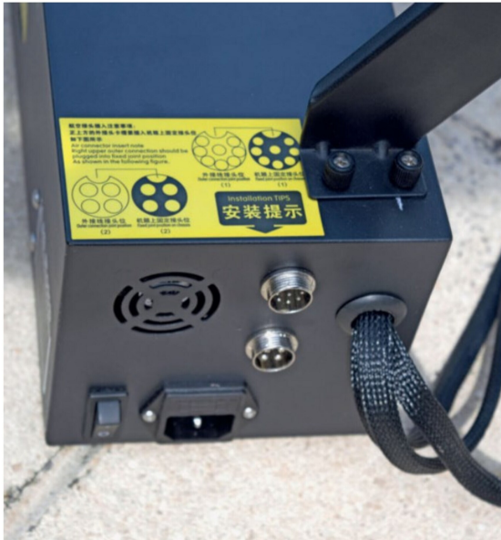
Auf der Rückseite der Box des CR10 sind die verpolungssicheren Anschlüsse.
