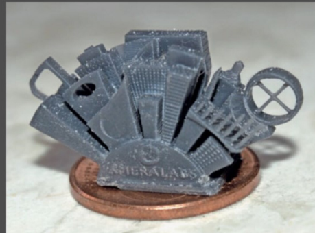
Der Duplicator D7 – ein Resin-Drucker – druckt mit sehr hoher Auflösung. Hier hat sich allerdings Wüstenstaub während des Aushärtens am Sonnenlicht abgesetzt.
