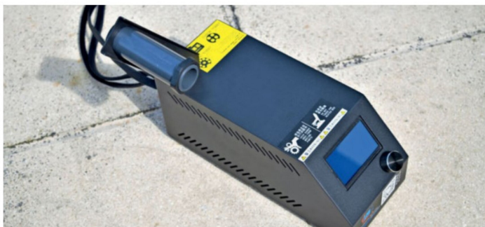
Im Gegensatz zu den anderen Geräten ist die Elektronik des Creality CR10 in einer externen Box.
